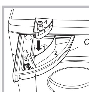
дозатор выше отметки «Макс.» на центральной шкале (см. рисунок). Для осуществления только отбеливания поместите отбеливатель в дополнительный дозатор 4 и задайте программу «Полоскание» и включите функцию «Отбеливание». Для отбеливания в процессе стирки засыпьте стиральный порошок и добавки, задайте нужную программу и включите
